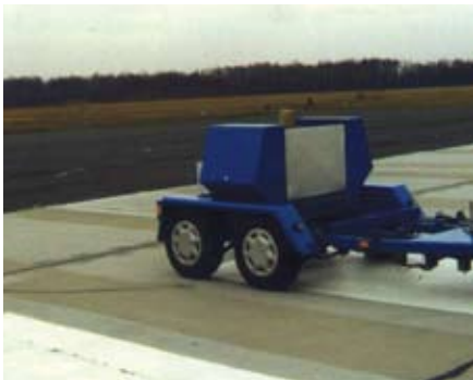
Urządzenie HWD służące do pomiaru nośności nawierzchni lotniskowych i drogowych
